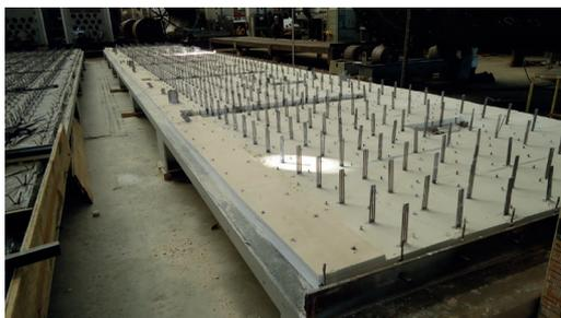
Painel da convecção de forno de coqueamento retardado, ancorados com grampos “tipo tridente” e primeira camada com placas de silicato de cálcio de 2”.
