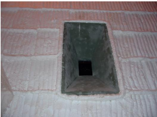
Aplicação de módulos de fibra cerâmica na parede internas da radiação em fornos cilíndricos.
